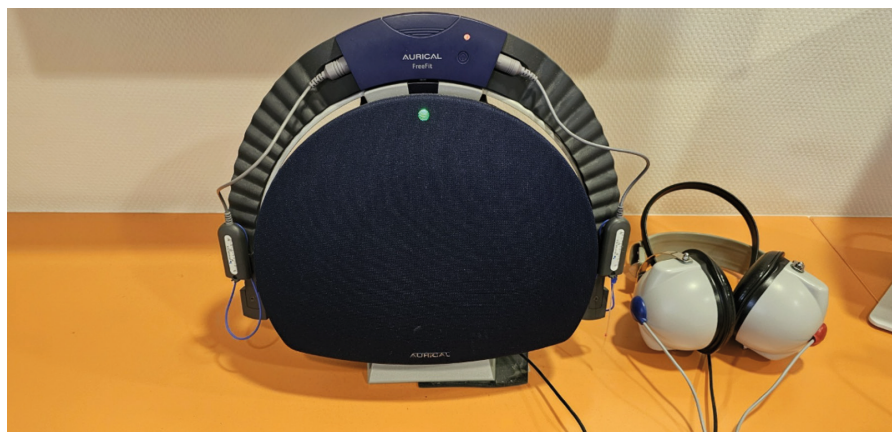
Figure n° 3 | Matériel Aurical® Freefit de mesure in vivo de chez Natus.
