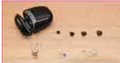
Figure n° 1 | Exemple d'un microcontour RITE avec différents dômes et embouts. Ces appareils sont reconnaissables par leur écouteur relié au micro-contour par un fil électrique.
